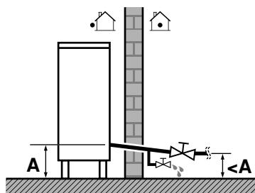
Cuando el agua se encuentra estancada en el interior del sistema es muy probable que se congele y cause daños en el sistema en funcionamiento.
