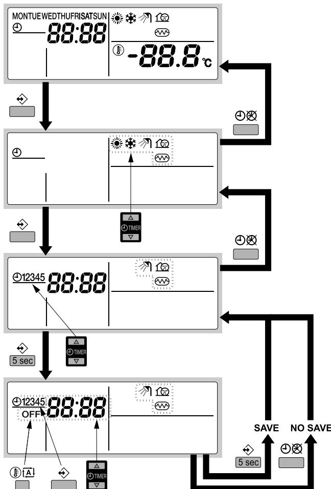
La programación del calentamiento del agua sanitaria, el calentamiento por resistencia eléctrica o el modo susurrante se realiza del siguiente modo:
