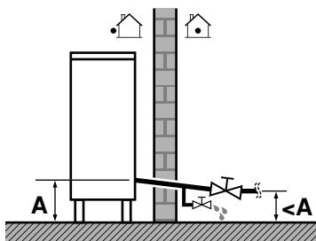
Lorsque l'alimentation est à l'arrêt à l'intérieur du système, le gel est susceptible de se produire et d'endommager le système dans le processus.
