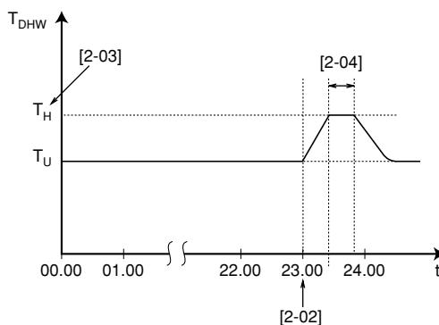
$T_{DHW}$  Temperatura del agua caliente sanitaria
